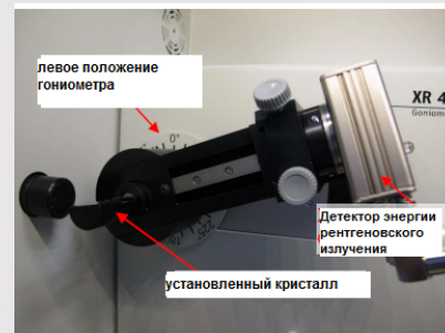
Рис. 4: Установка гониометра
