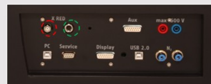
Рис. 4: Подключение многоканального анализатора
