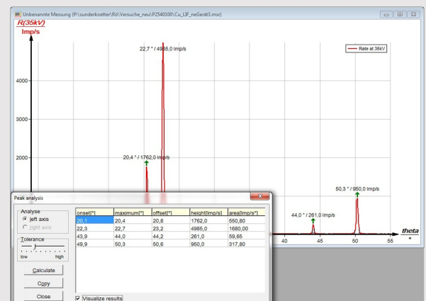
Рис. 14: Автоматический анализ пиков с помощью measure.
