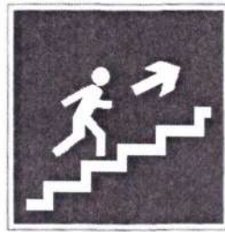
Направление к эвакуационному выходу по лестнице вверх
